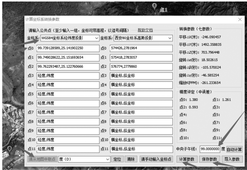
图 1 计算坐标转换参数
