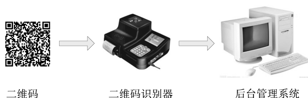
图 2 二维码监测定位系统
